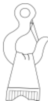
图 D.1 图中显示了吊钩直径太小时，与织带环眼结合的不充分
